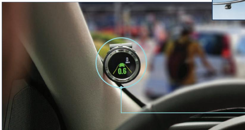
EyeWatch™ 显示器用于显示视觉警报，安装在挡风玻璃底角。
