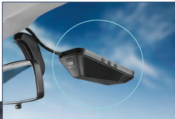
摄像头总成包括摄像头、EyeQ® 芯片和扬声器，安装在挡风玻璃内侧，后视镜后方的位置。
